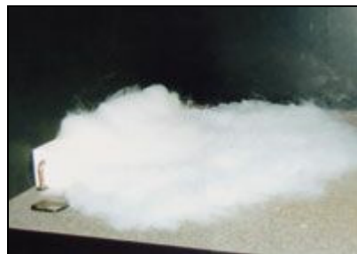
Rys. 8.4. Wizualizacja strumienia powietrza nawiewanego z nawiewnika cokolikowego w przypadku chłodzenia
