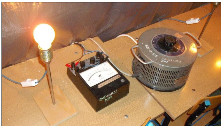
autotransformator z watomierzem
