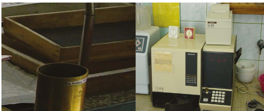
Fot. 4. Podstawowe wyposażenie i czynności w laboratorium badawczym: a) sita do oceny dystrybucji rozkładu wymiarów ziaren; b) spektrometr do oceny wilgotności oraz określenia ilości glutenu i białka
