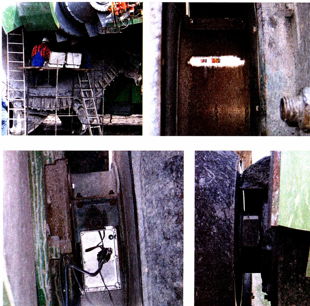
Rys. 3.11. Przygotowanie torów pomiarowych do pomiaru momentu skręcającego i zginającego na wale koła czepakowego (koparka KWK 1200M)
