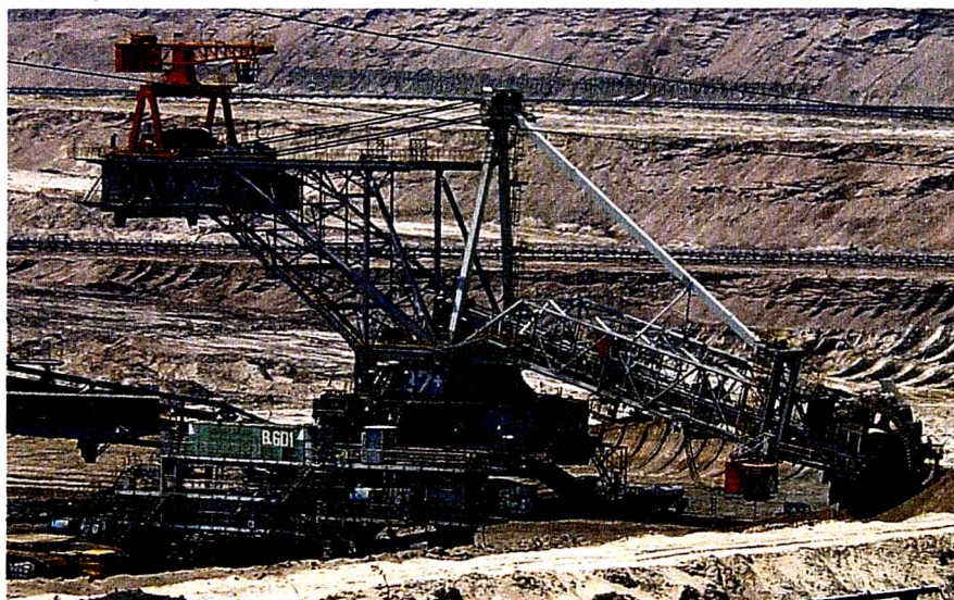
Rys. 2.2. Uniwersalna węglowo-nadkładowa koparka kołowa SRs 2000
