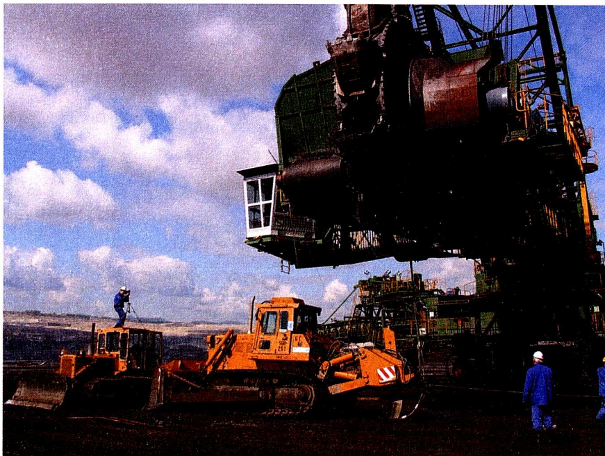
Rys. 7.3. Widok koparki podczas skalowania siłą pionową, z lewej strony kamera do rejestracji przemieszczeń pionowych
