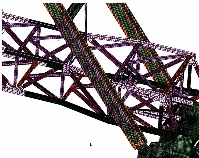
Rys. 9.2. Widok modelu dyskretnego powłokowego dolnej części wsiężnicy ze wzmocnieniem
