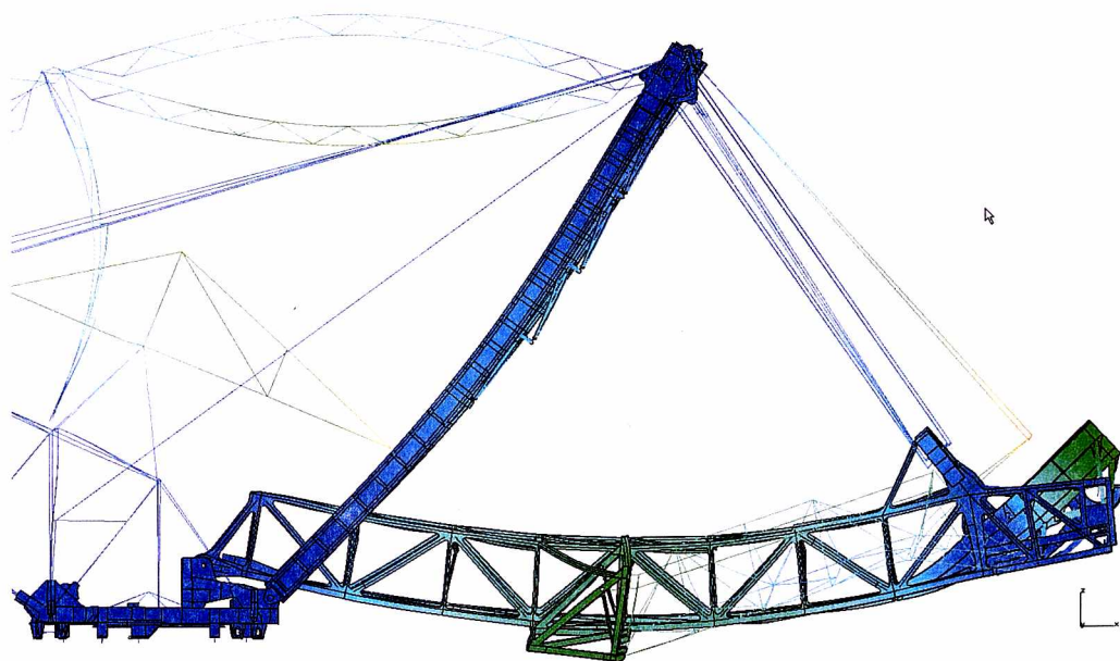
Rys. 8.9. Dwudziesta ósma postać drgań nadwozia koparki f = 3,79 Hz
