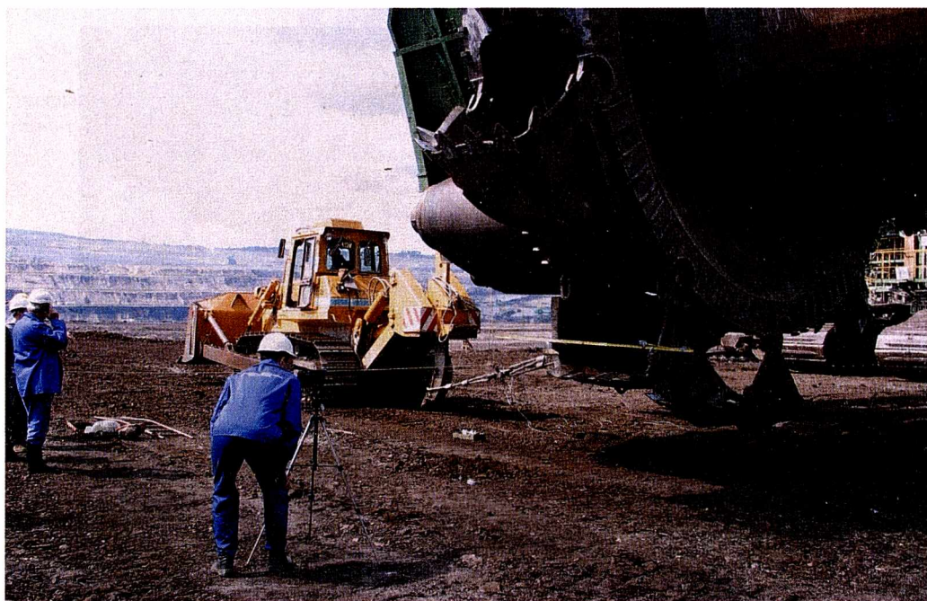
Rys. 7.6. Skalowanie siłą poziomą z rejestracją przemieszczeń poziomych
