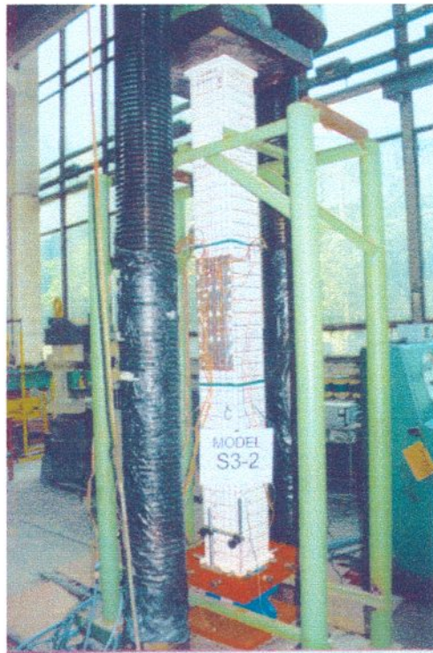
Rys. 4.9. Model S3-2 na stanowisku badawczym
