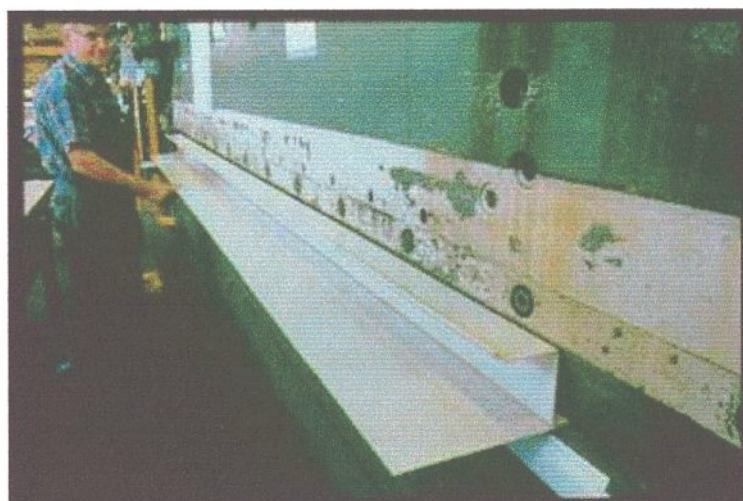
Rys. 2.2. Kształtowanie na krawędziarce
