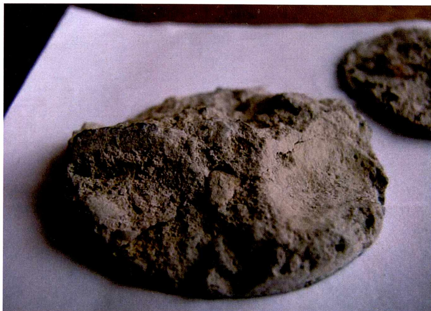
Rys. 3.24. Krążek betonu z badań pull-off
