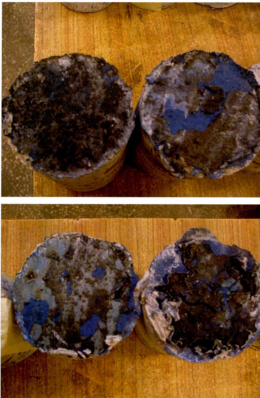
Rys. 3.23. Narośla i uszkodzenia wewnętrznej powłoki ochronnej na odwiertach rdzeniowych pobranych do badań
