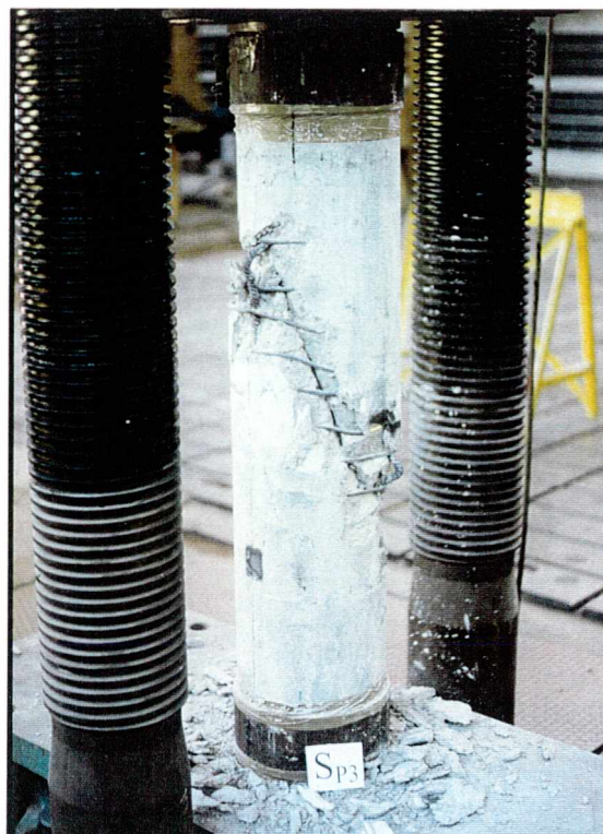
Rys.4.26. Zniszczenie słupów uzwojonych:
