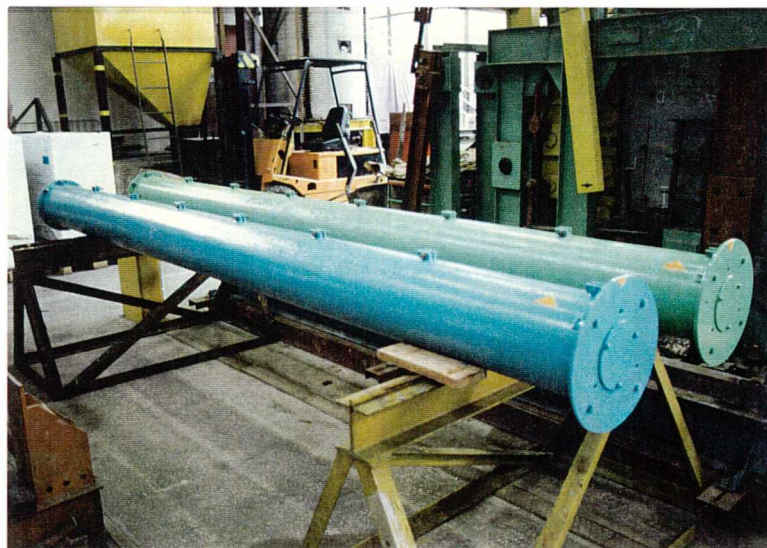
Rys.4.4. Formy do wykonywania elementów wirowanych (seria II)
