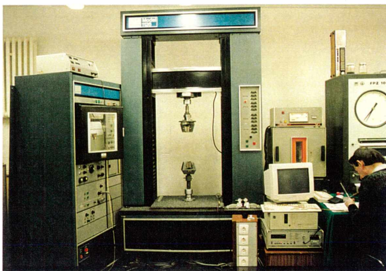
Rys.4.15. Maszyna wytrzymałościowa INSTRON Model 1126 do badań próbek stali
