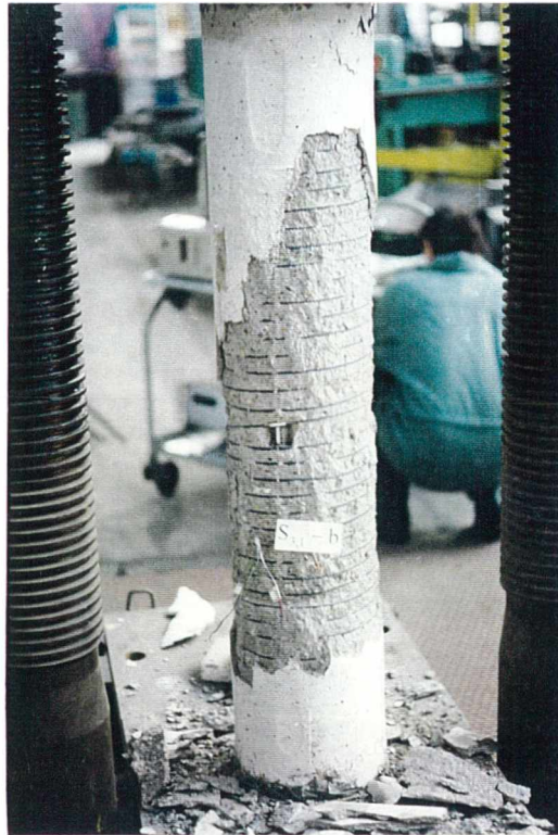
Rys.6.13. Element badawczy po zniszczeniu
