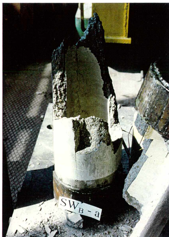
Rys.4.57. Zniszczenia betonowego elementu wirowanego przez zgniecenie betonu
