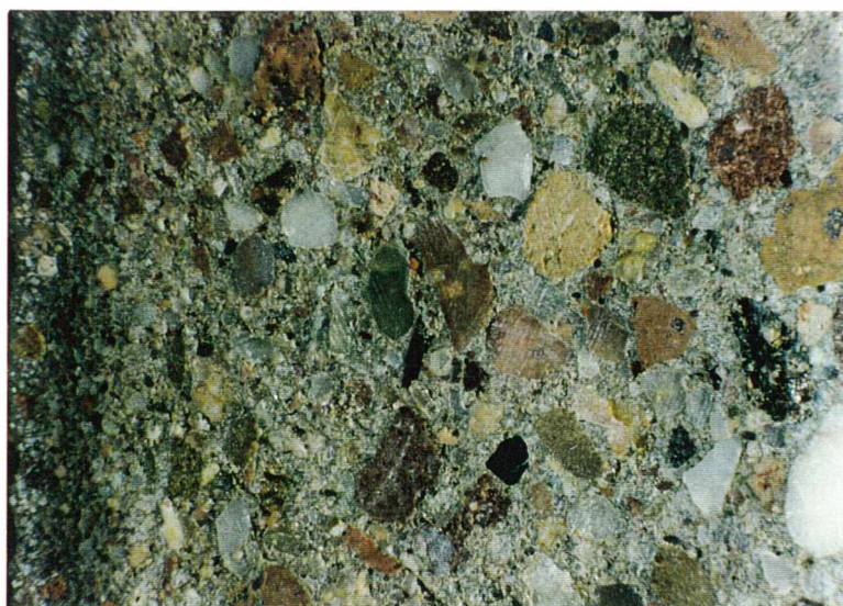
Rys.4.54. Struktura betonu wirowanego
