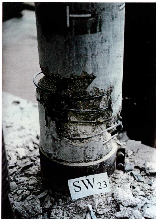
Rys.4.56. Zniszczenie wirowanych słupów uzwojonych:
