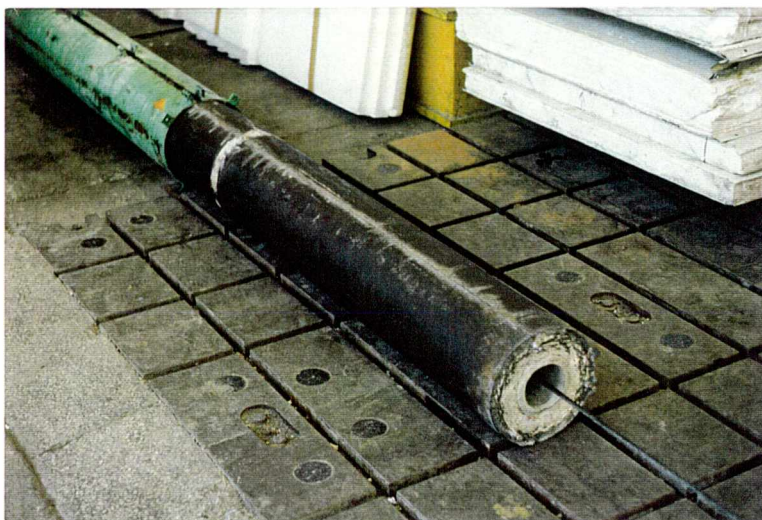
Rys.4.11. Wyciąganie gotowego elementu z formy podstawowej
