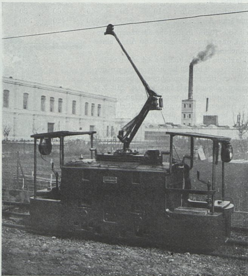
Abb. 366. Rollenstromabnehmer für große Höhenunterschiede der Fahrleitung (S.S.W.).
