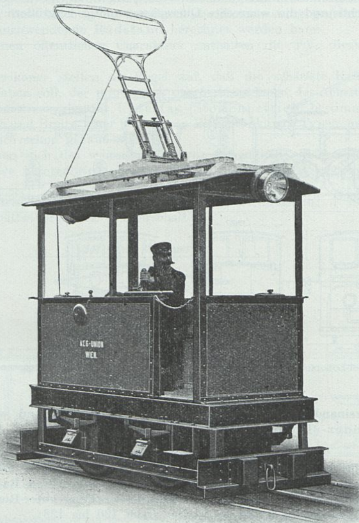
Abb. 420. Obertag-Lokomotive für eine Industriebahn. Achsfolge 2 A. 2 Motoren innenliegend (A.E.G.U.).
