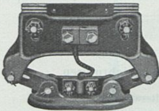
Abb. 383. Stromabnehmer für Stromschiene, Berührungsdruck durch Eigengewicht erzeugt.
