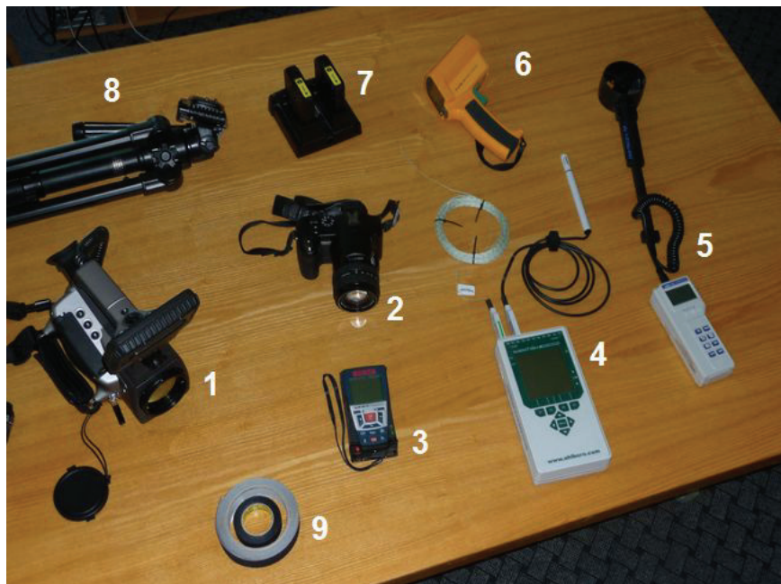
Rys. 6.2. Podstawowy sprzęt operatora kamery termowizyjnej: 1) kamera termowizyjna, 2) aparat fotograficzny, 3) dalmierz laserowy, 4) rejestrator z sondami do pomiaru temperatury i wilgotności względnej powietrza oraz temperatury powierzchni przegród (termopary), 5) anemometr z rejestratorem do pomiaru prędkości wiatru, 6) pirometr, 7) zapasowe akumulatory do kamery, 8) statyw, 9) czarna matowa taśma samoprzylepna
