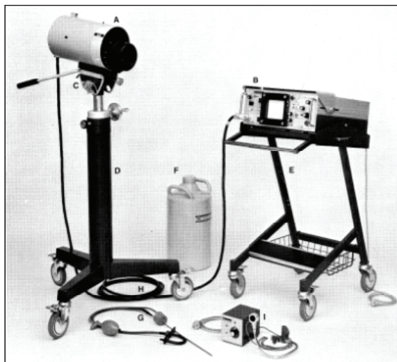
Rys. 1.1. Kamera termowizyjna AGA Thermovision Model 680, popularna w Polsce w latach 70. ubiegłego stulecia, od 1978 r. do dnia dzisiejszego na wyposażeniu Zakładu Fizyki Budowli i Komputerowych Metod Projektowania w Instytucie Budownictwa Politechniki Wrocławskiej [92]
