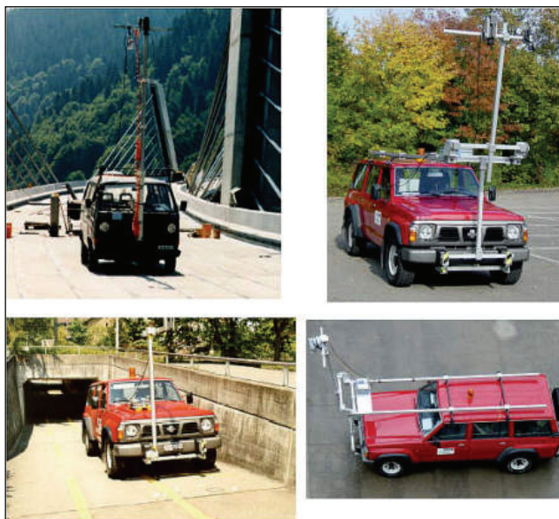
Rys. 6.122. Mobilne stanowisko pomiarowe nawierzchni dróg i chodników mostowych (po lewej stronie pokazano unowocześnione stanowisko pomiarowe, obecnie stosowane) [170]
