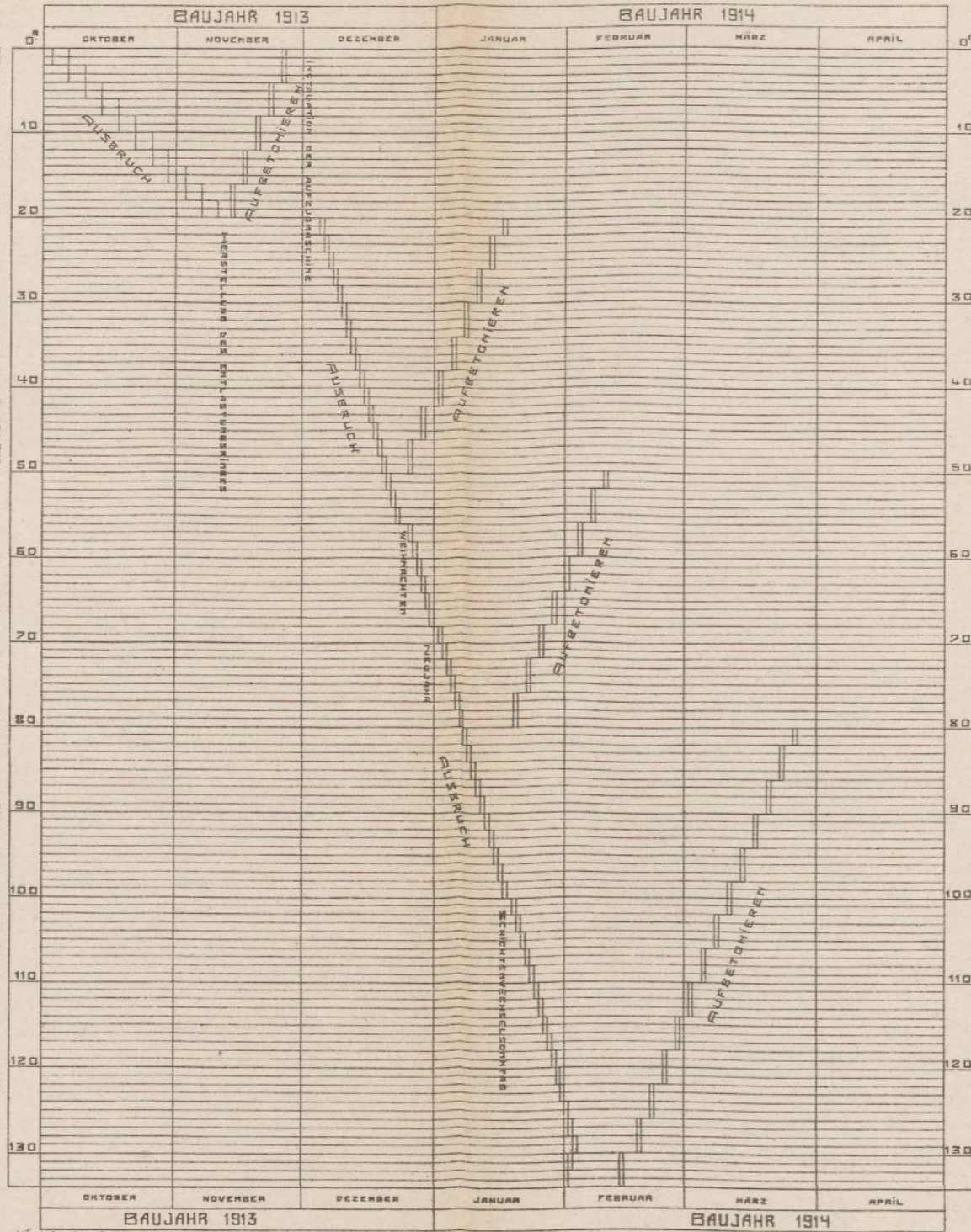
ARBEITSVORGANG BEIM AUFBETONIEREN DES SCHACHTES MIT HILFE DER EISERNEH LEHRKONSTRUKTION SCHNITT 1:90
