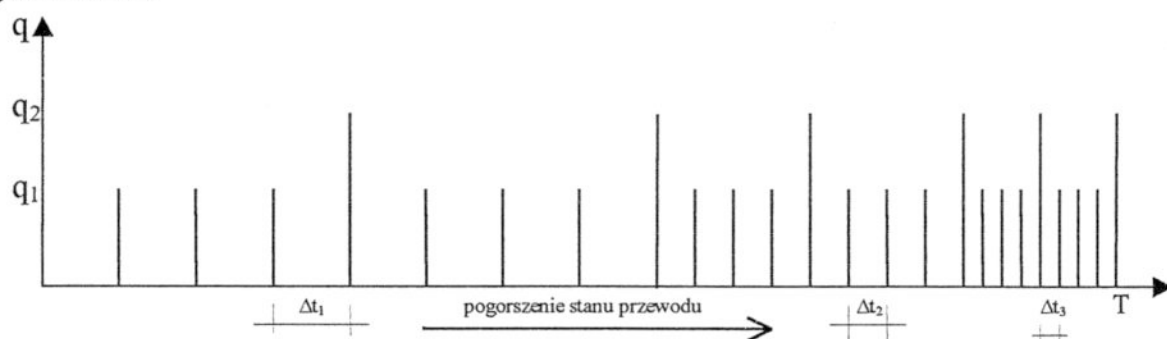
Rys.5.9. Program kontroli dwustopniowej o zmiennej częstości kontroli q - współczynnik dokładności kontroli; T - okres amortyzacji, \Delta t_i - okres między kontrolami
