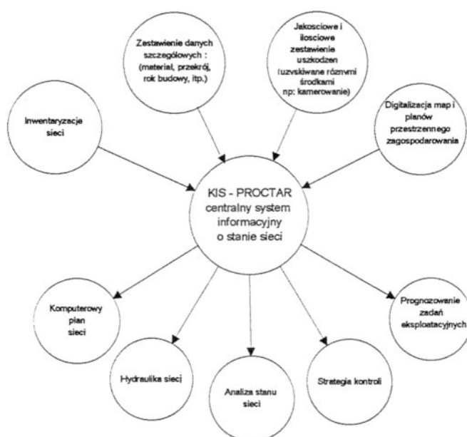
Rys.1.2. Schemat wymiany informacji w systemie KIS - PROCART [94]
