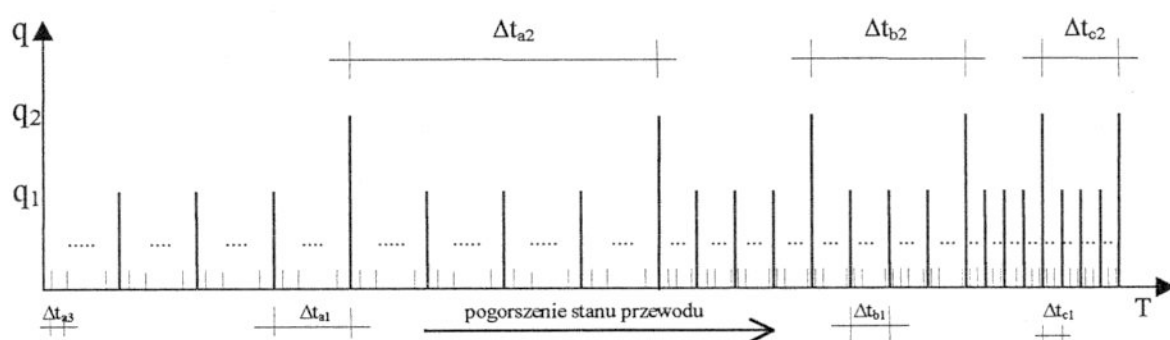
Rys.5.10. Program kontroli dwustopniowej o zmiennej częstotliwości kontroli
