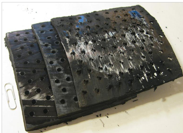
Rys. 1.2. Widok przykładowej dużej próbki po pierwszym etapie kalcynowania na palniku gazowym. Widoczne są otwory oraz możliwość wstępnego rozwarstwienia próbki
