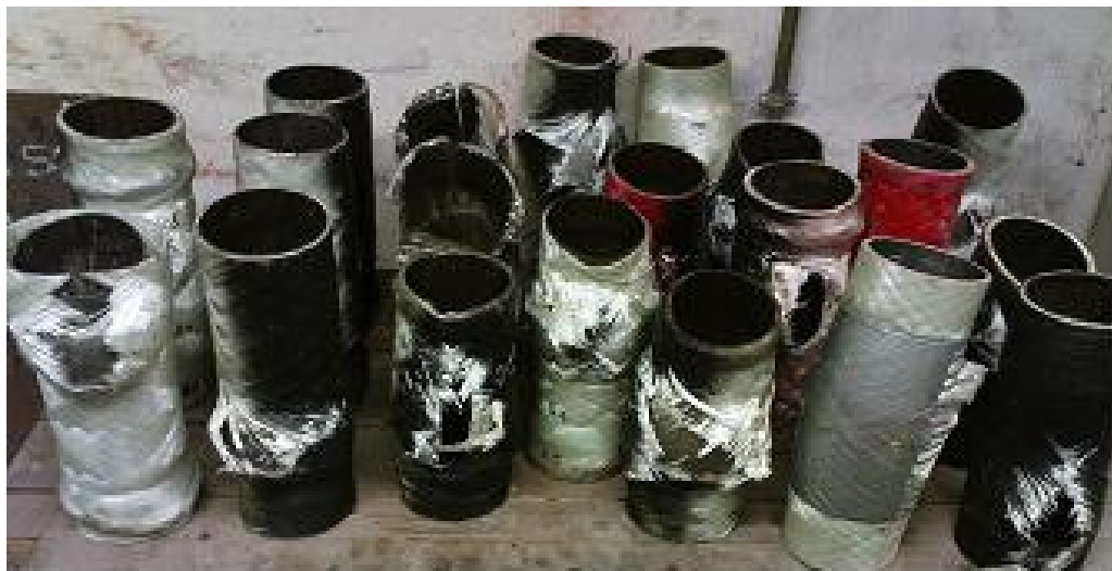
Rys. 6.15. Widok części walcowych butli po badaniach zmęczeniowych z wykorzystaniem pulsatora hydraulicznego
