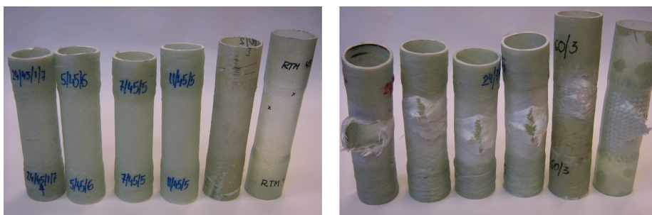
Rys. 5.15. Widoki wszystkich sześciu próbek przed i po badaniach; w kolejności, pierwsze cztery to nawijane według wzorów N_r 1, 5, 7 i 11, pozostałe dwie to wypłatane; przedostatnia zwilżana żywicą z użyciem wałka i ostatnia formowana ciśnieniowo metodą RTM
