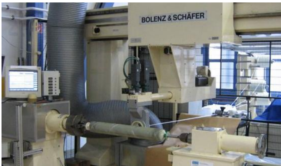
Rys. 5.21. Wytwarzanie butli z użyciem nawijarki firmy Bolenz & Schäfer w laboratorium ILK TU Drezno
