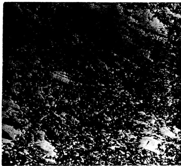
Rys.3.3.17. Struktura stopu B odkształconego do \varepsilon = 2,43 z prędkością 0,1s^{-1} w temp. 873K. Widoczne liczne, drobne zrekrytalizowane ziarna, pow.x100
