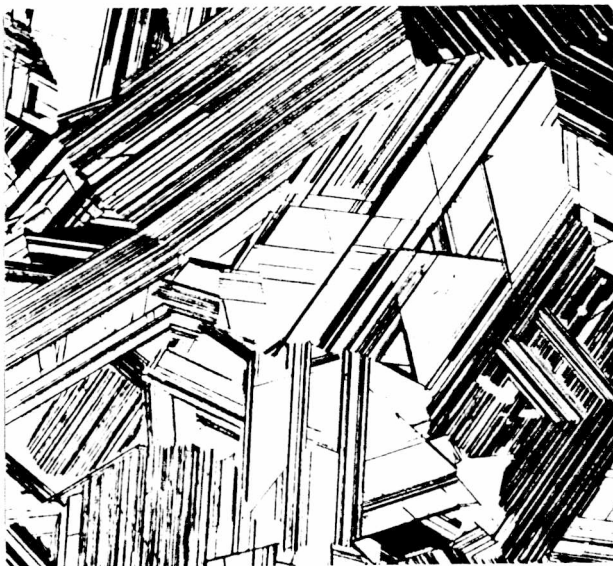
Rys.3.3.27. Struktura stopu C przed rozpoczęciem odkształcania, pow.x150
