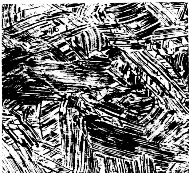
Rys.3.3.44. Struktura stopu D po odkształc. do \epsilon=0,15 w temp.873K z prędk.odkształc. 0,6s^{-1} , pow.x150
