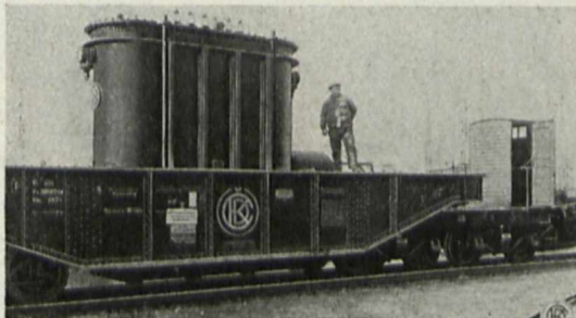
Rys. 8. Transformator trójfazowy o mocy 48 000 kVA, dostarczony do kopalni Karolina Witkowskich hut żelaznych w Morawskiej Ostrawie. (Dotychczas największy transformator w Czechosłowacji).
