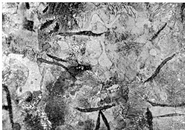
Rys. 1. — Mikrostruktura pierścienia tłokowego z żeliwa chromowo-miedziowo-tytanowego; a. szlif nietrawiony (powierzchnia 100 x) b. szlif trawiony (powierzchnia 500 x).
