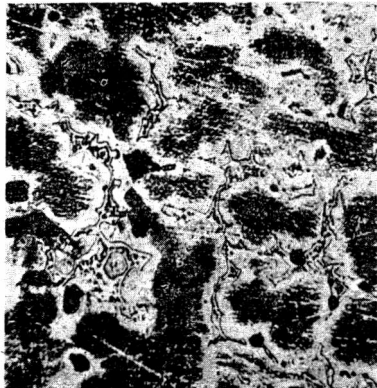
Rys. 6. Mikrostruktura stopu CuSn10Pb10 odlanego do form metalowych, trawiono chlorkiem żelaza, pow. 200 × [28]
