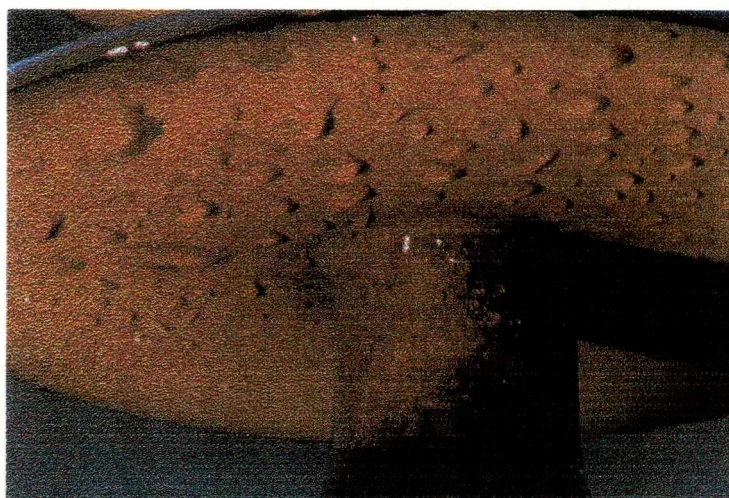
Rys. 4.2.6 Niska zwilżalność dolnej powierzchni klosza na izolatorze kompozytowym po około 20 letnim okresie eksploatacji.
