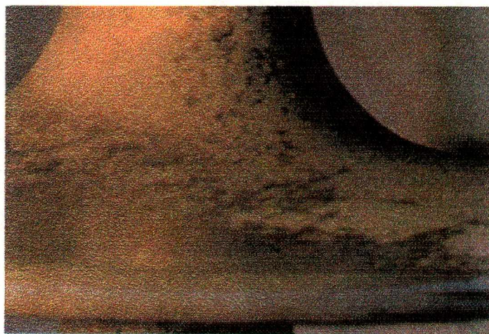
Rys. 4.2.3 Hydrofilna krawędź klosza izolatora kompozytowego.
