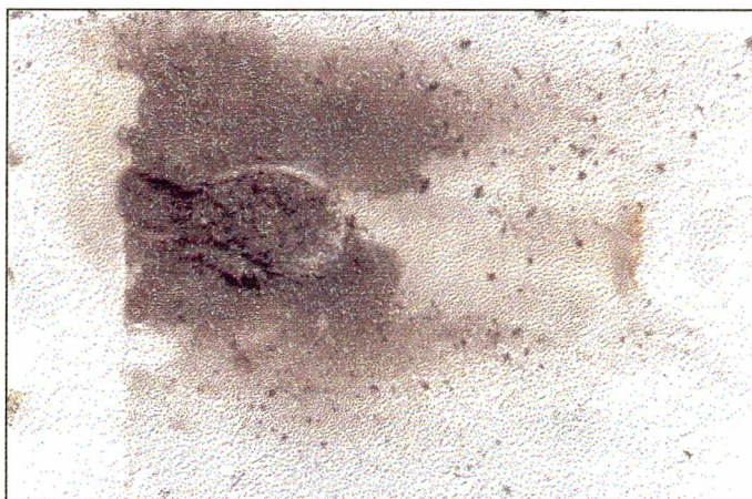
Rys. 7.4.12. Erozja zabrudzonego pokrycia RTV spowodowana długotrwałym przepływem prądu (po około 20 godzinach) w zmodyfikowanym teście pochylej próbki.
