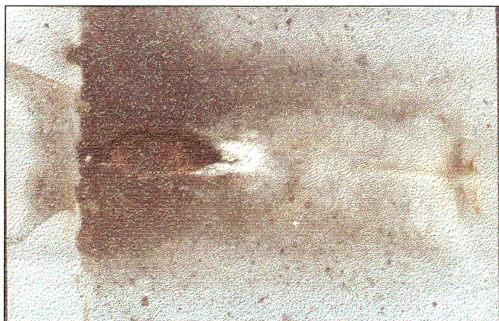
Rys. 7.4.10. Erozja czystego pokrycia RTV spowodowana długotrwałym przepływem prądu (po około 36 godzinach) w zmodyfikowanym teście pochylej próbki.
