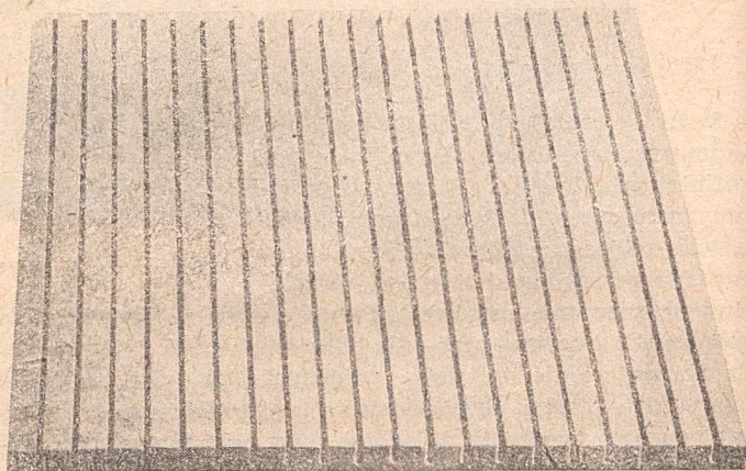
Rys. 7 — Płyta pilśniowa porowata nacinana (dźwiękochłonna).
