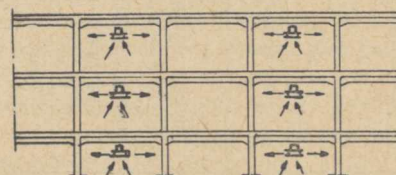
Rys. 11. „Rotatherm A” bez osłony blaszanej dla pomieszczeń do 4 m wysokości
