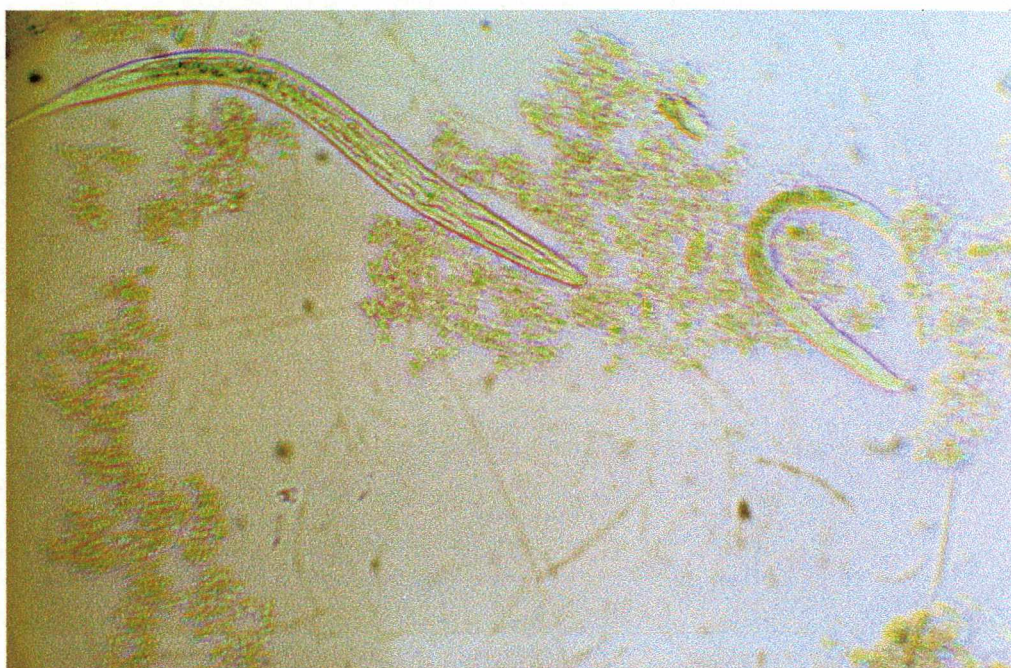
Fot. 9.12 Mikroskopowy obraz osadu czynnego z reaktora AL. Widoczne nicienie Plectus sp.. Powiększenie 320 x
