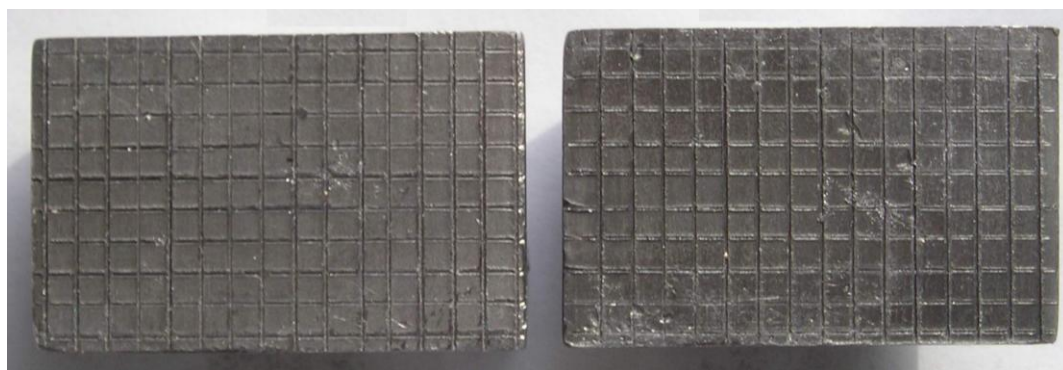
Rys. 6.5.4. Próbkę ołowiu z siatką koordynacyjną przed wyciskaniem
