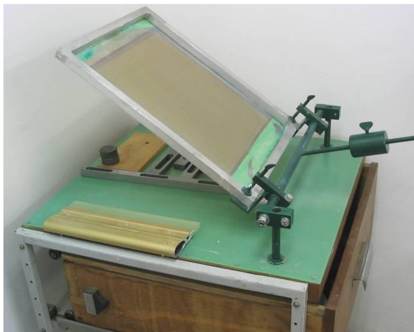
Rys. 5.2.5. Stanowisko do nanoszenia siatek koordynacyjnych metodą sitodruku
