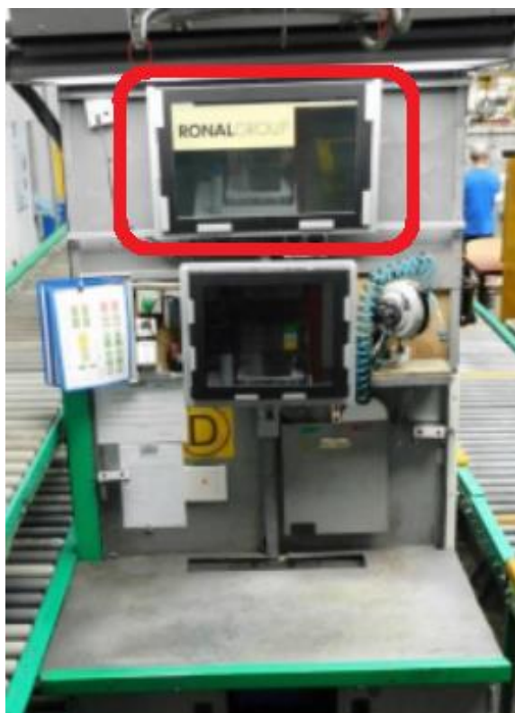
Rys. 8.2. Przykładowe, udoskonalone stanowisko kontroli wyjściowej wyrobu gotowego
