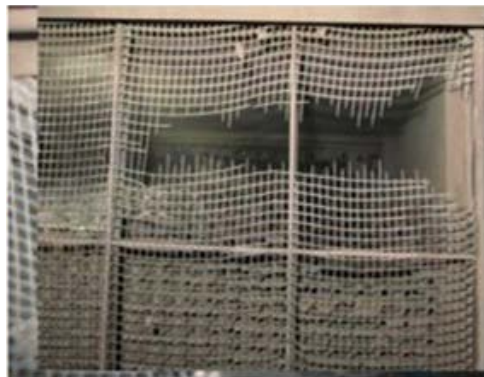
Rys. 4.2. Katalizator uszkodzony mechanicznie – układ high-dust : a) wygięcie katalizatora, b) perforacja katalizatora
