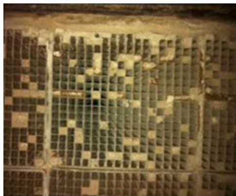
Rys. 4.3. Katalizator zatkany przez pył – układ high-dust : a) widok katalizatora, b) powiększenie zatkanych otworów katalizatora
