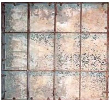
Rys. 4.3. Katalizator zatkany przez pył – układ high-dust : a) widok katalizatora, b) powiększenie zatkanych otworów katalizatora
