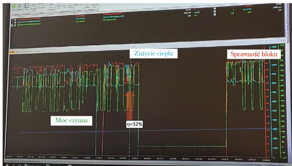
Rys. 1.35. Zdjęcia z przebiegiem charakterystyki sprawności bloku (23.12.2022): widoczna skala sprawności; kolor czerwony – sprawność [%] (min : skok : max = 0 : 3 : 40); kolor zielony – moc czynna generatora [MWe] (min : skok : max = 0 : 50 : 1000), kolor niebieski – jednostkowe zużycie ciepła potrzebne do wytworzenia 1 kWh energii elektrycznej (HR) [kJ/kWh] (min : skok : max = 0 : 1000 : 12 000)
