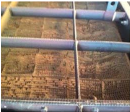
Rys. 4.2. Katalizator uszkodzony mechanicznie – układ high-dust : a) wygięcie katalizatora, b) perforacja katalizatora
