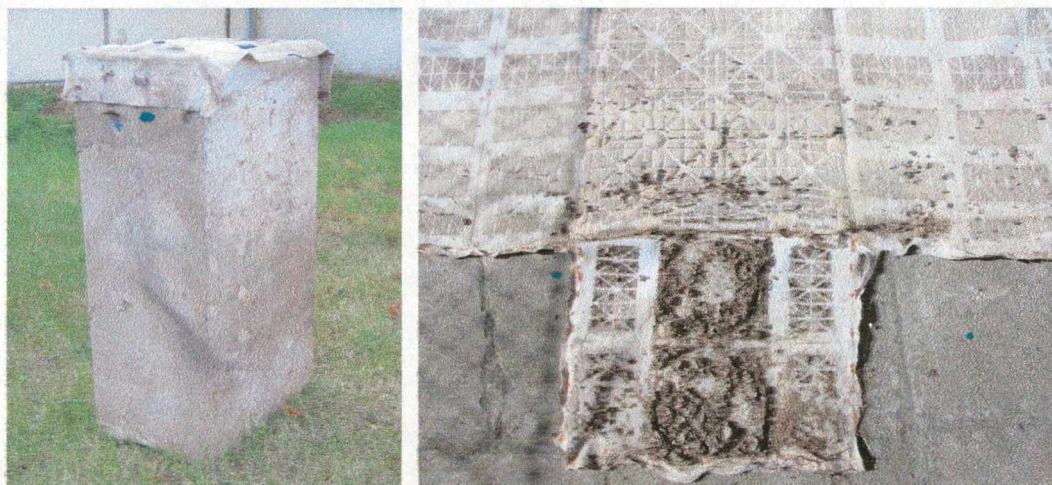
Rys. 96. Wygląd skrzyni 1 (zalewanej zawiesziną bentonitu) po wyjęciu z gruntu oraz rozmieszczenie osadu na geowłókninie od strony wewnętrznej
