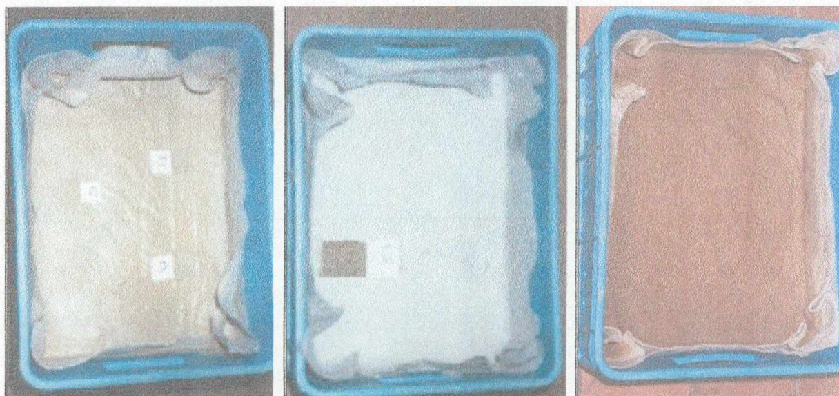
Rys. 72. Widok osadu (od lewej) bentonitu odłożonego na powierzchni geowłókniny TS 10, kaolinu odłożonego na geowłókninie TS 20 i gliny odłożonej na geowłókninie TS 20
