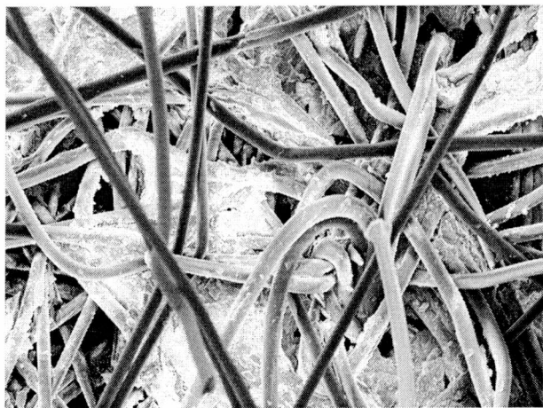
Rys. 86. Zdjęcia skaningowe osadu bentonitu odłożonego w geowłókninie TS 10 wykonane przy powiększeniu 250 razy (po lewej) i 1000 razy (po prawej)
