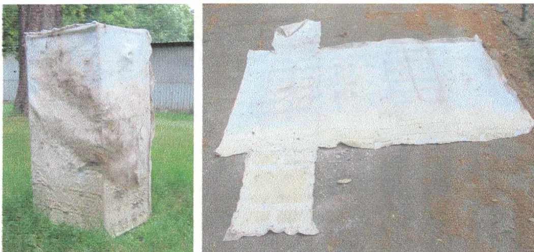
Rys. 98. Wygląd skrzyni 3 (zalewanej zawiesiną kaolinu) po wyjęciu z gruntu oraz rozmieszczenie osadu na geowłókninie od strony wewnętrznej
