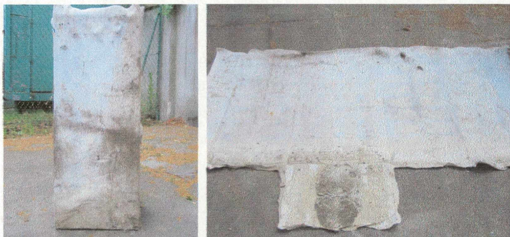
Rys. 97. Wygląd skrzyni 2 (zalewanej zawiesziną kaolinu) po wyjęciu z gruntu oraz rozmieszczenie osadu na geowłókninie od strony wewnętrznej
