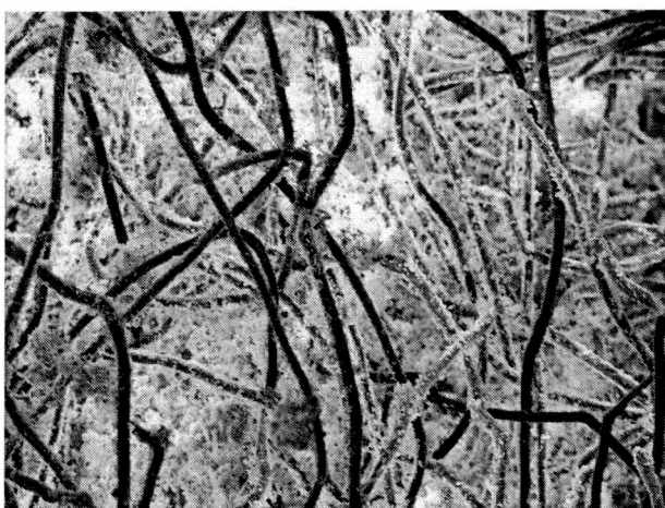
Rys. 113. Zdjęcia skaningowe osadu kaolinu odłożonego w geowłókninie na dnie skrzyni 3 przy powiększeniu 250 razy (po lewej) i 1000 razy (po prawej)
