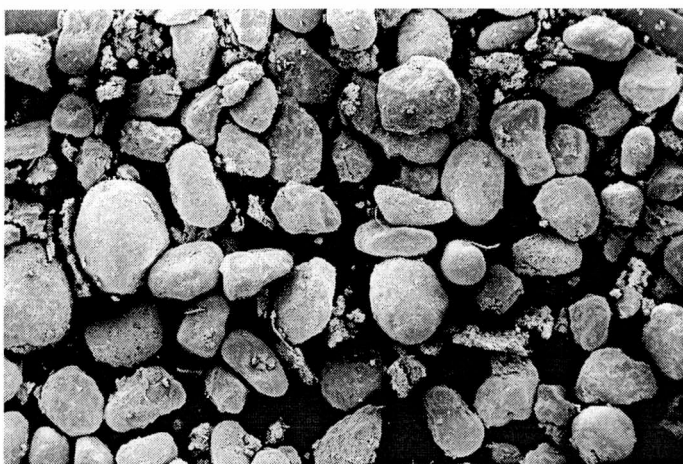
Rys. 62. Zdjęcie skaningowe złoża pod geowłókniną TS 50 w miejscu poboru próby P8 wykonane przy powiększeniu 50 razy
