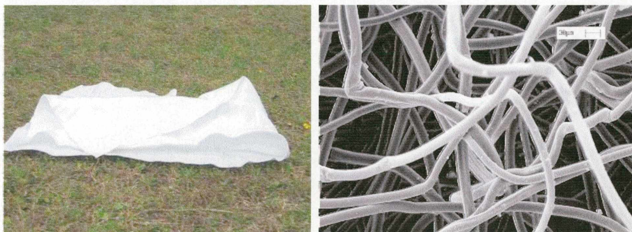
Rys. 13. Wygląd geowłókniny PP150 oraz jej zdjęcie skaningowe
