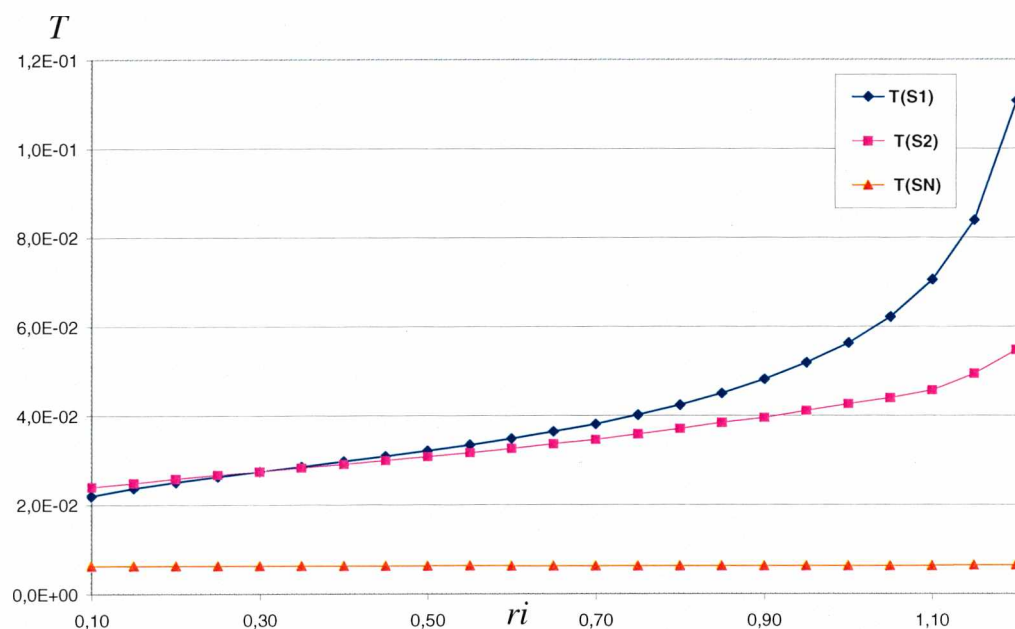
Rys. 3.19. Zależność wartości średniego opóźnienia pakietów w sieciach 1. poziomu oraz w sieci 2. poziomu sieci HSK-212 od parametru ri , dla budżetu B = 11080
