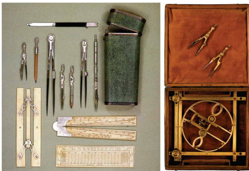
Rys. 2.9. Ewolucja instrumentów kreślarskich 31 : po lewej – kieszonkowy przyborek kreślarski z 1782 r., po prawej – elipsograf z 1815 r.
