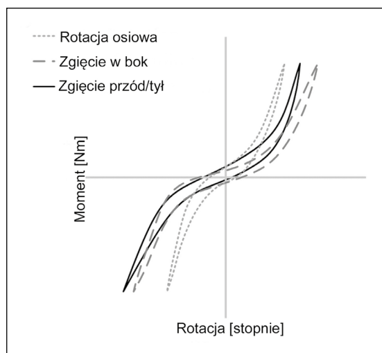
Rys. 6.6. Typowa charakterystyka obciążenia realizowanego w trzech różnych płaszczyznach w funkcji zmiany kąta segmentu ruchowego kręgosłupa [Newell 2017]
