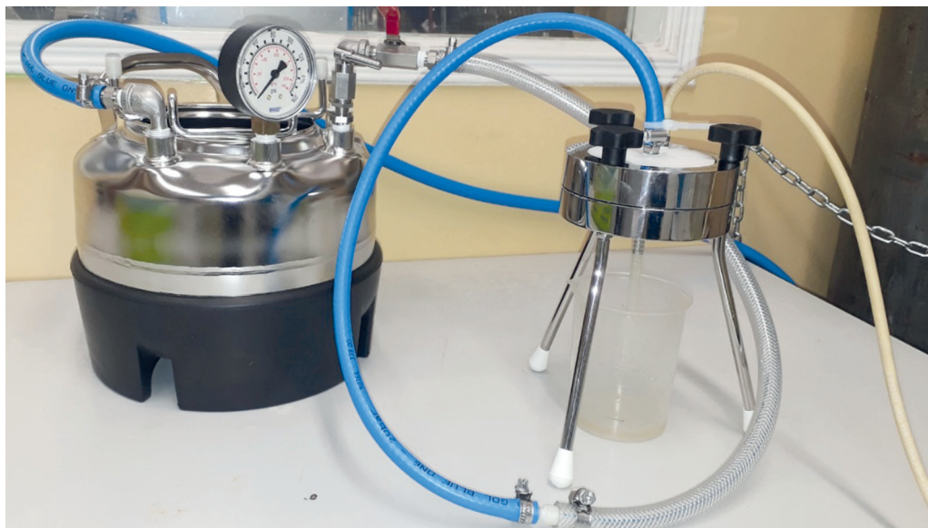
Rys. 7.7. Instalacja laboratoryjna firmy Sterlitech do filtracji ciśnieniowej
