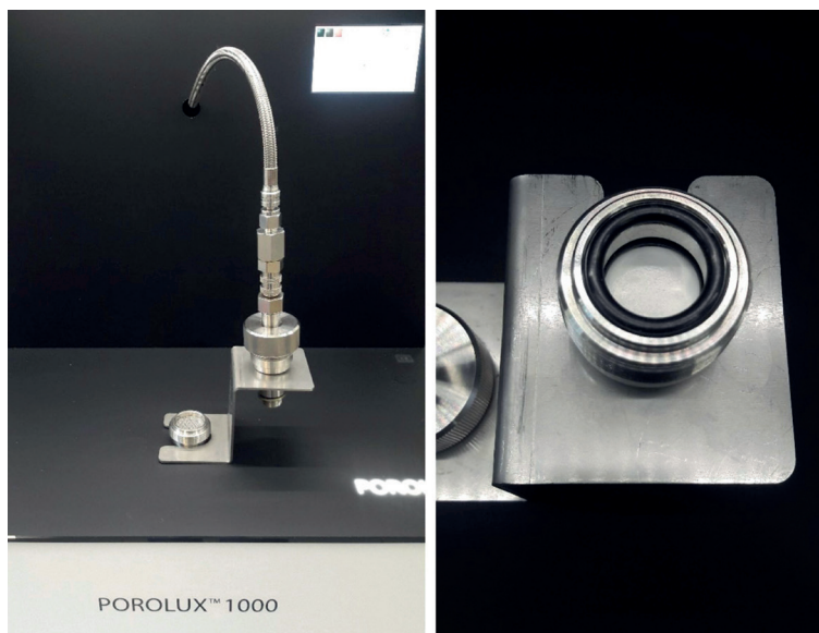
Rys. 7.17. Użyty w badaniach porometr POROLUX TM 1000 z uchwytem na próbki
