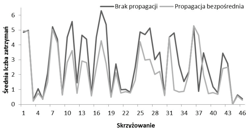
Rys. 5.11. Średnia liczba zatrzymań na pasach dojazdowych do skrzyżowań
