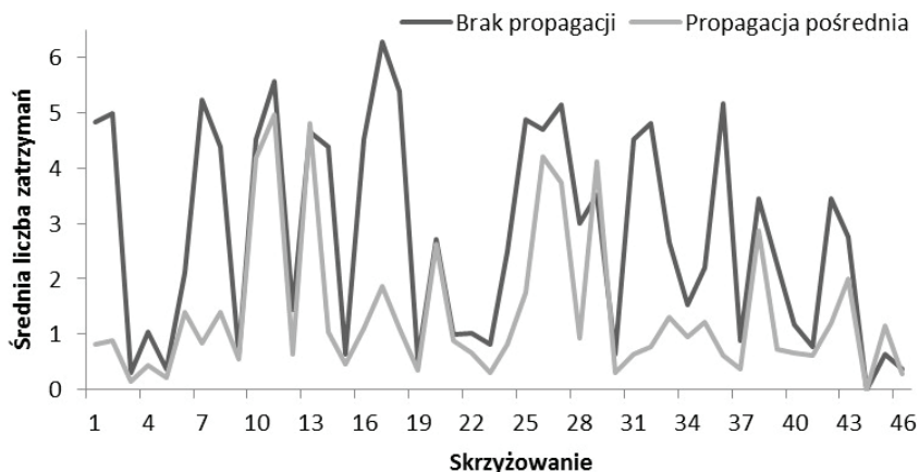
Rys. 5.8. Średnia liczba zatrzymań na pasach dojazdowych do skrzyżowań
