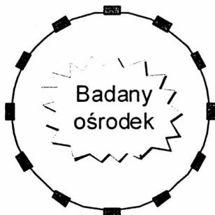
Rys. 4-9. Pomiar układem czujników
