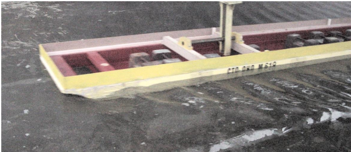
Rys. 6.17. Zdjęcie układu falowego barki SFKO h=2,0\text{m} T=1,7\text{m} V_s=7,5\text{ km/h}
