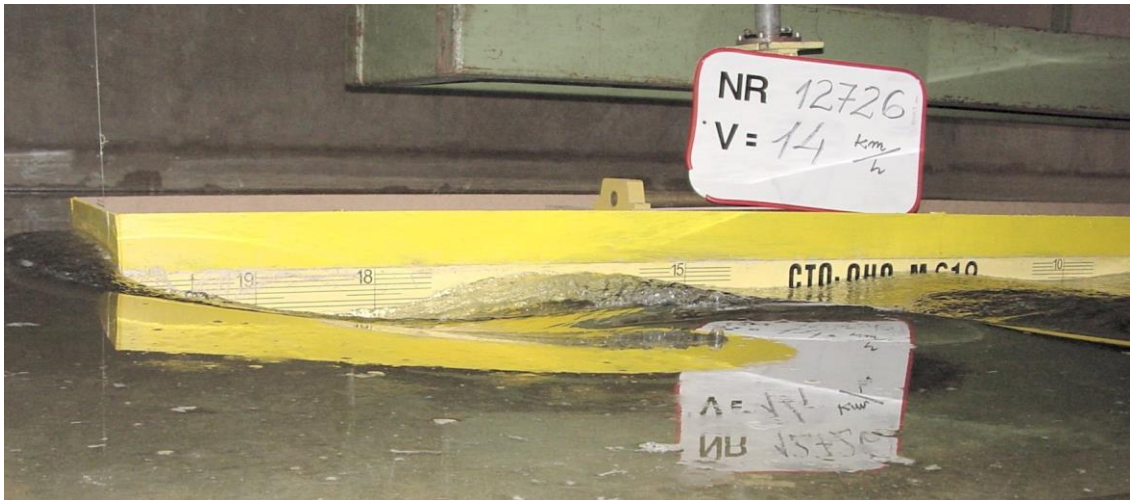
Rys. 6.15. Zdjęcie układu falowego barka SFKO h=5,0\text{m} T=1,7\text{s} V_s=14\text{ km/h}
