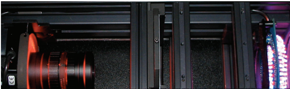
Rys. 7.12. Obraz głowicy wizyjnej do inspekcji czół wałeczków łożysk, pokazujący dwa oświetlacze
