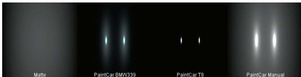
Rys. 6.64. Obrazy luminacji powierzchni dla różnych parametrów rozpraszania światła
