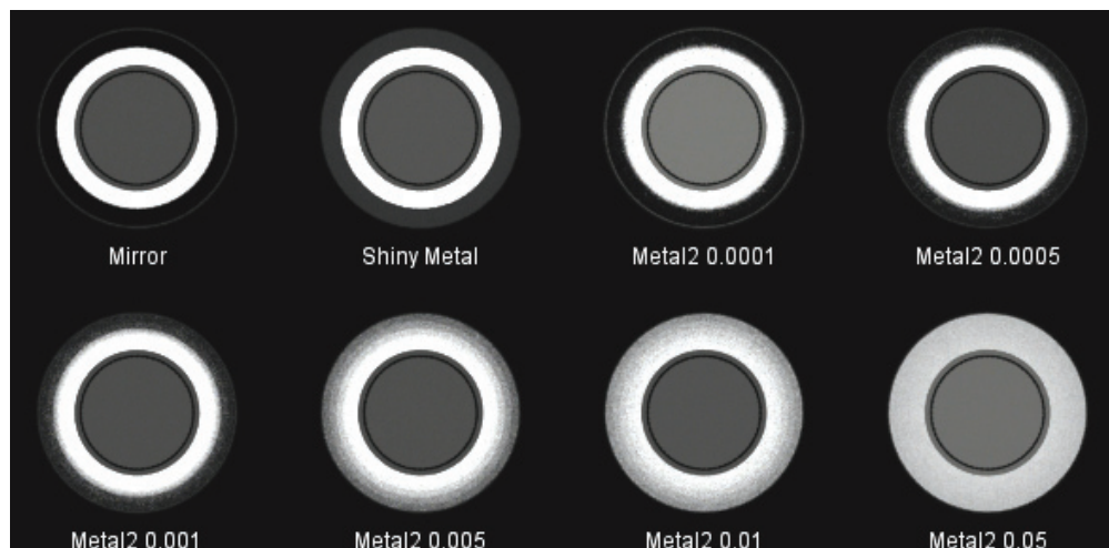
Rys. 7.3. Obrazy czoła powierzchni w funkcji jej rozpraszalności
