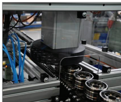
Rys. 7.20. Fotografie stanowiska inspekcji przegubów homokinetycznych po wdrożeniu
