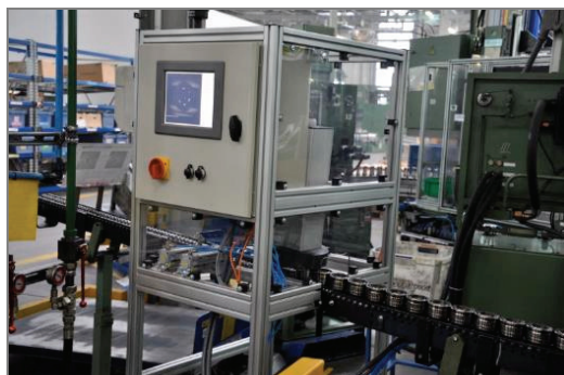
Rys. 7.20. Fotografie stanowiska inspekcji przegubów homokinetycznych po wdrożeniu
