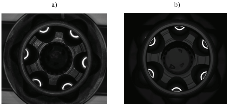
Rys. 7.18. Obrazy przegubu z dodatkowym doświetleniem: a) obraz z kamery, b) wynik renderowania
