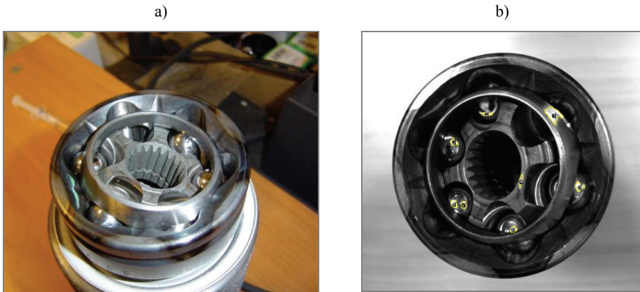
Rys. 7.15. Fotografie przegubu homokinetycznego: a) zdjęcie poglądowe, b) z zaznaczonymi obszarami najjaśniejszymi
