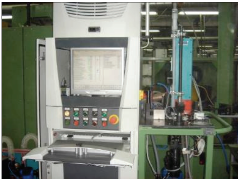
Rys. 7.14. Stanowisko do inspekcji czoła wałeczków łożysk
