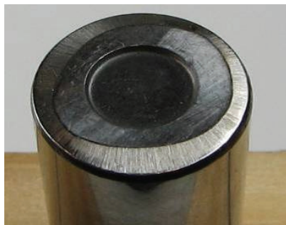
Rys. 7.1. Fotografia wałeczka z wadą typu „podwójny szlif”
