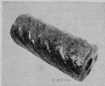
Rys. 4. Napawany korpus freza NFWa-80x90 w stanie surowym.
