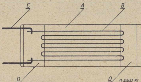
Rys. 1. Elementy konstrukcyjne tensometru elektrooporowego.
