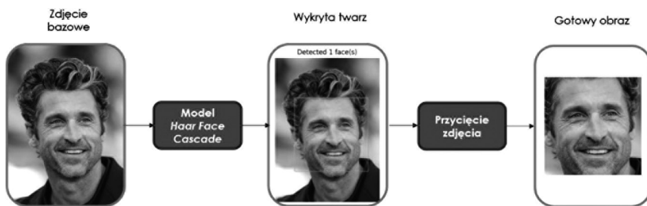
Fot. 1. Przetwarzanie zdjęcia za pomocą modelu detekcji twarzy Haar Face Cascade
