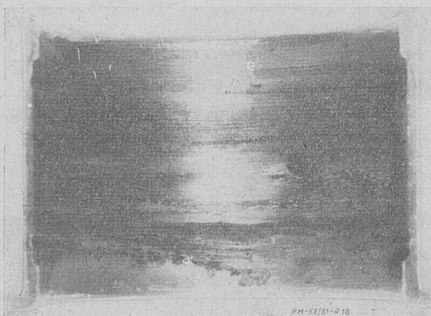
Rys. 18. Panewka wylana stopem Cu-Pb w początkowym stanie zacierania się.
