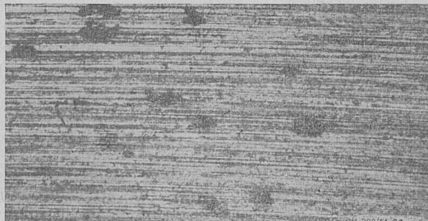
Rys. 9. Powierzchnia natarcia ostrza napawanego po szlifowaniu (×20).
