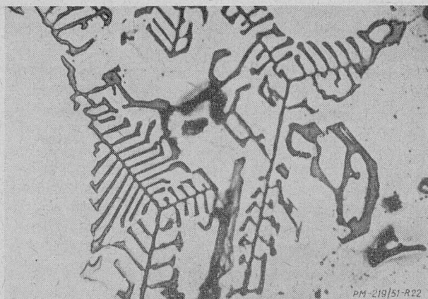
Rys. 22. Wieloskładnikowy stop aluminium polerowany i trawiony elektrolitycznie. Pow. 500×.
