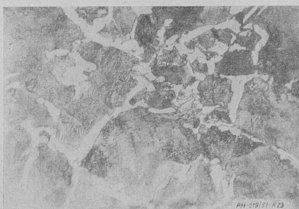
Rys. 23. Staliwo węglowe polerowane i trawione elektrolitycznie. Pow. 500×.
