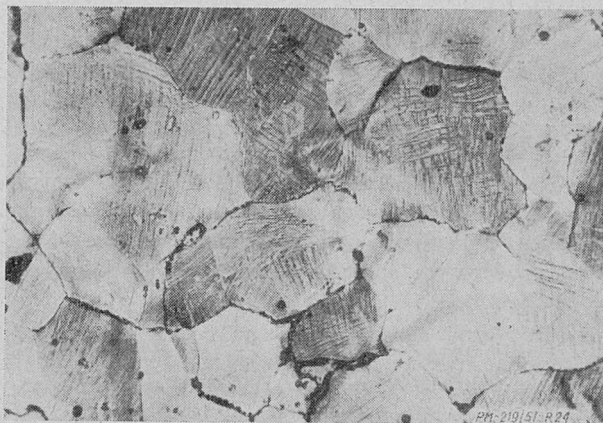
Rys. 24. Staliwo Hadfielda polerowane i trawione elektrolitycznie. Pow. 100×
