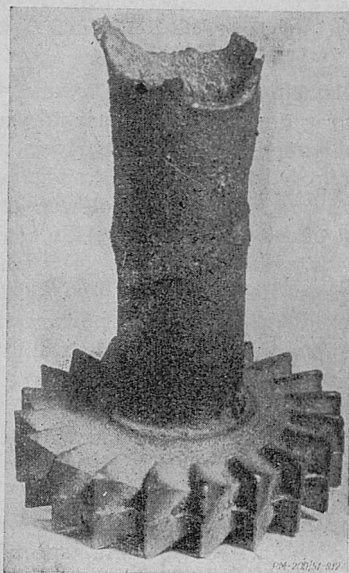
Rys. 12. Frez tarczowy trzystronny NFTA 72×10 mm odlany w formie piaskowej w Zakładzie Odlewnictwa Akademii Górniczo-Hutniczej.
