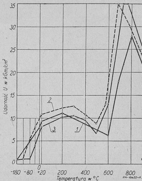
Rys. 3. Udarność stali niskowęglowych (z rys. 2) w zależności od temperatury [8].
