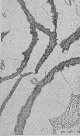
Rys. 1. Struktura żeliwa szarego ferrytycznego; powiększenie 500 \times (zmniejszono \times 0,75 ) trawiono azotalem.
