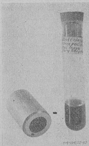
Rys. 5. Spiekane łożysko samosmarujące i probówka zawierająca olej, który może się pomieścić w jego porach.
