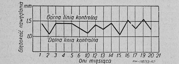
Rys. 2. Wykres kontrolny wyników pomiarów głębokości nawęglania sworzni tłokowych.
