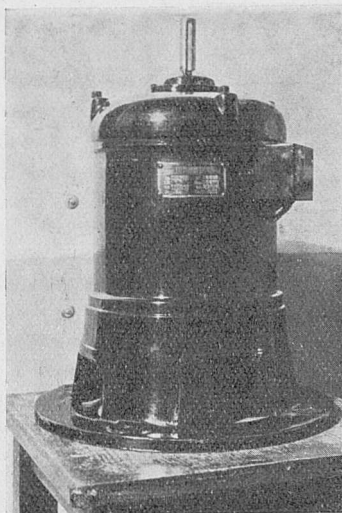
Rys. 8. Silnik pionowy zamknięty zwarty 1,5 KM 1450 obr.
