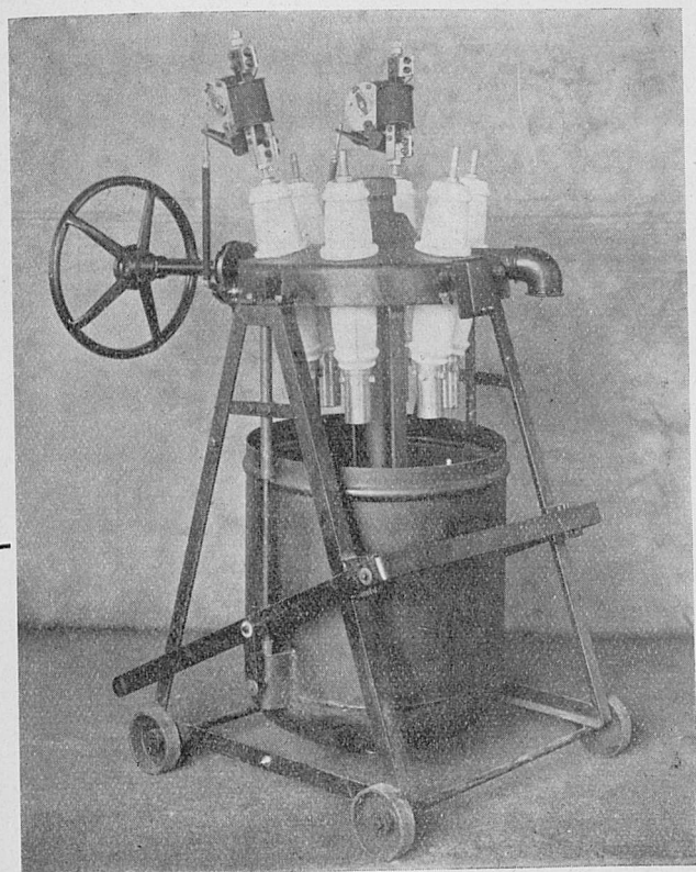
Wyłączniki olejowe samoczynne. Typ do 10 kV oraz typ dla dużych mocy zwarcia do 35 kV. Pokrywa i zbiornik — prasowana grubą blachą. Izolatory — rozmieszczone koncentrycznie. Kontakty — wtykowe koncentryczne. Części uziemione — usunięte z wnętrza całkowicie. Zamek — nieskomplikowany i pewny. Sprężyna wyłączająca — centralna, jedna, niezawodna.
