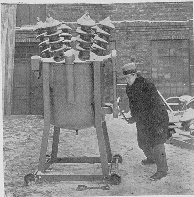
Wyłączniki olejowe samoczynne. Typ do 10 kV oraz typ dla dużych mocy zwarcia do 35 kV. Pokrywa i zbiornik — prasowana grubą blachą. Izolatory — rozmieszczone koncentrycznie. Kontakty — wtykowe koncentryczne. Części uziemione — usunięte z wnętrza całkowicie. Zamek — nieskomplikowany i pewny. Sprężyna wyłączająca — centralna, jedna, niezawodna.
