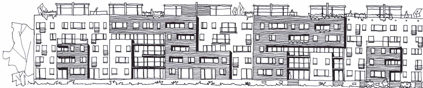
Il. 4.70. Osiedle Bolesława Krzywoustego, ul. Kielczowska 125–131: a) elewacja południowa istniejącego 5-kondygnacyjnego budynku. Można zauważyć próbę urozmaicenia elewacji poprzez stosowanie powtarzalności w co drugiej kondygnacji, a nie – jak to zwykle spotyka się w zabudowie wielkopłytkowej – na każdej kondygnacji, b) widok zmodernizowanego budynku (autorka B. G.)
