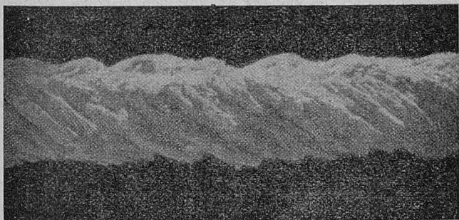
Rys. 8. Osad lodowy na pojedynczym przewodzie o średnicy 48 mm
