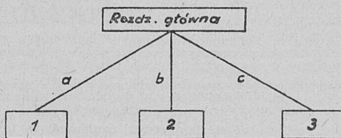
Rys. 2. Pojedynczo-promieniowy układ rozdzielczy
