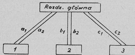
Rys. 3. Podwójnie-promieniowy układ rozdzielczy
