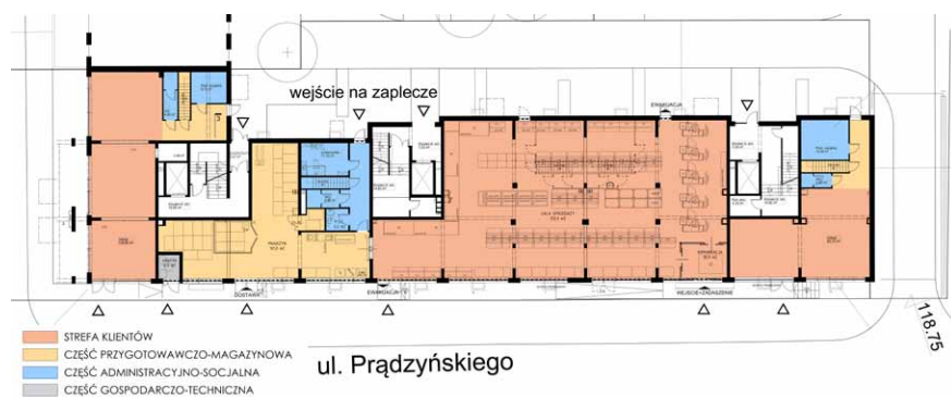
Il. 74. Rzut usług (supermarketu) w parterze kwartału budynku usługowo-mieszkaniowego przy ulicy Prądyńskiego 47–63 we Wrocławiu. Opracowanie własne na podstawie materiałów archiwalnych Autorskiej Pracowni Projektowej Konarzewski
