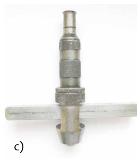
Rys. 4.16. Młotki Schmidta do badań sklerometrycznych zaprawy spoin [W17] (a) i ceramicznych elementów murowych (b) oraz młotek Waitzmanna (c) [70]
