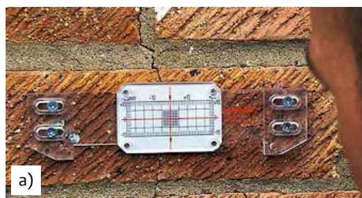
Rys. 5.2. Wskaźniki rozwartości rys: a) szczelinomierz płytkowy [W3], b) wskaźnik z prążkami Moiré'a [W13]
