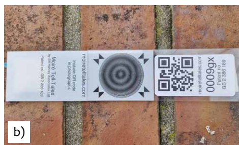
Rys. 5.2. Wskaźniki rozwartości rys: a) szczelinomierz płytkowy [W3], b) wskaźnik z prążkami Moiré'a [W13]
