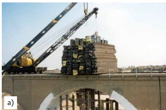
Rys. 5.9. Badania MMS pod obciążeniem statycznym balastem (a) [194] i ruchomym pojazdem (b)
