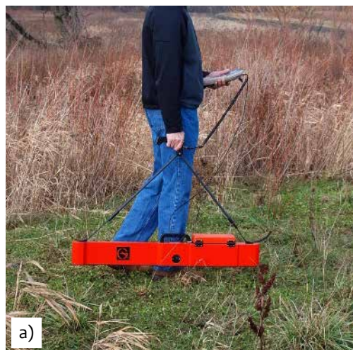
Rys. 4.24. a) Badanie bezkontaktowe pomiaru oporności elektrycznej gruntu [W11], b) przykład uzyskanego obrazu przestrzennego rozkładu oporności [228]
