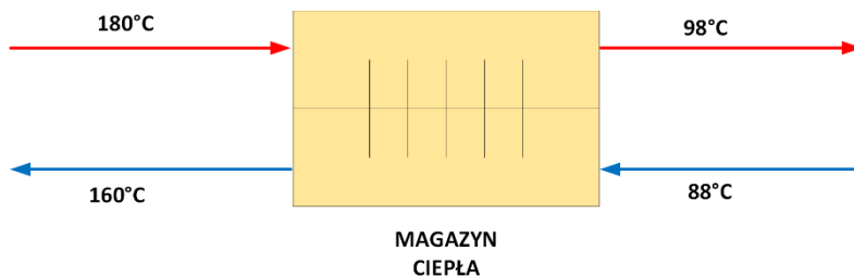
Rys. 3.6. Schemat magazynu ciepła z parametrami czynników roboczych
