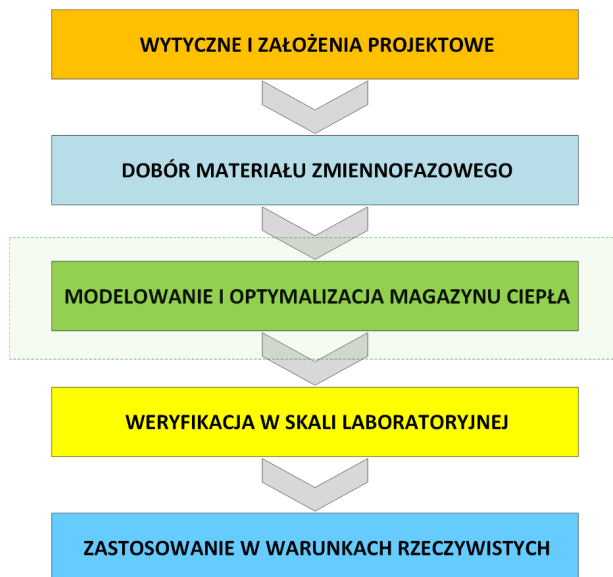
Rys. 2.1. Schemat blokowy procesu kompleksowego projektowania zmiennofazowego akumulatora ciepła
