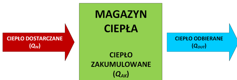
Rys. 4.1. Schemat bilansu cieplnego zmiennofazowego magazynu ciepła
