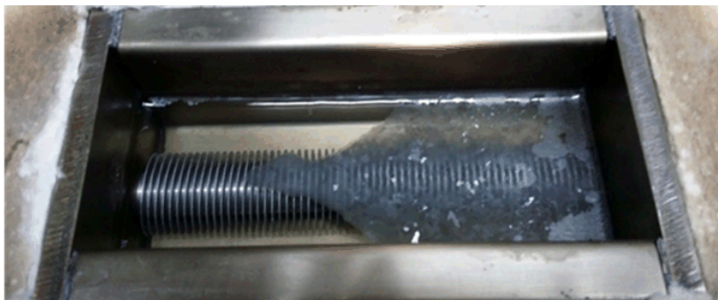
Rys. 5.27. Układ wymiany ciepła w postaci rury stalowej z ożebrowaniem aluminiowym po cyklicznym procesie ładowania–rozładowania magazynu ciepła wypełnionego solą \text{NaNO}_3 ; nie stwierdzono degradacji chemicznej ani mechanicznej
