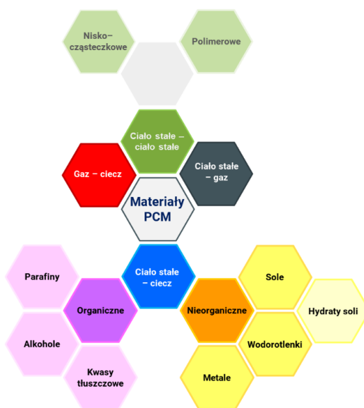
Rys. 1.4. Klasyfikacja materiałów zmiennofazowych ze względu na rodzaj przemiany fazowej
