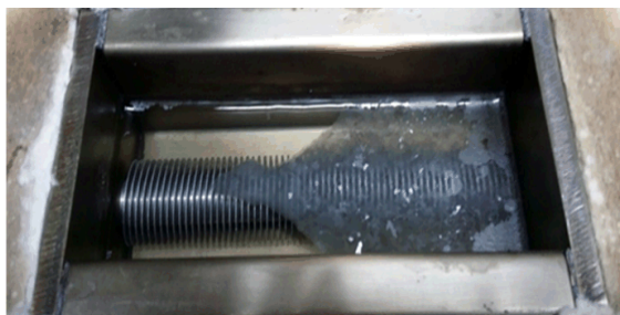
Rys. 4.11. Wewnętrzna część laboratoryjnego magazynu ciepła wypełnionego materiałem zmiennofazowym w fazie częściowego stopienia
