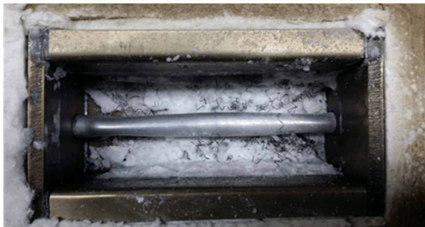
Rys. 5.26. Układ wymiany ciepła w postaci rury aluminiowej po cyklicznym procesie ładowania-rozładowania magazynu ciepła wypełnionego solą \text{NaNO}_3 ; widoczne znaczne deformacje rury
