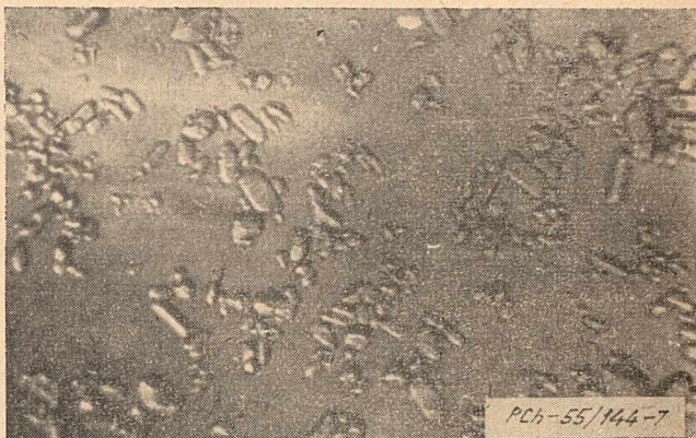
Rys. 7. Powiększenie 150 razy. Kryształ otrzymany przez c. wł. elektrolitu 1,407. Gęstość prąd. D_A = 1,85 \text{ A/cm}^2 . Wydajność prąd. W_p = 70,6\%
