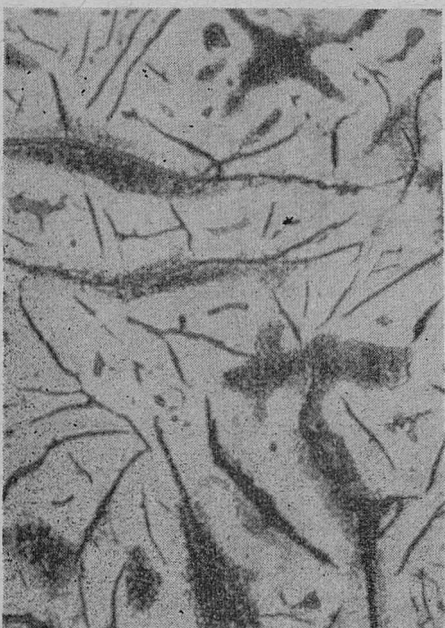
Rys. 8 — Żeliwo stopowe 5,74% Al (traw. kw. azot.)
