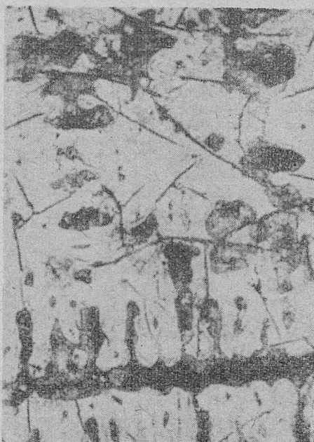
Rys. 12—Żeliwo stopowe 2,12% Al, 0,62% Cr, 0,55% Cu (traw. kw. azot.)
