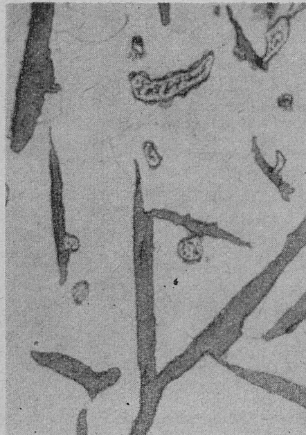
Rys. 9 — Żeliwo stopowe 2,16% C, 3,94% Al (traw. kw. azot.)
