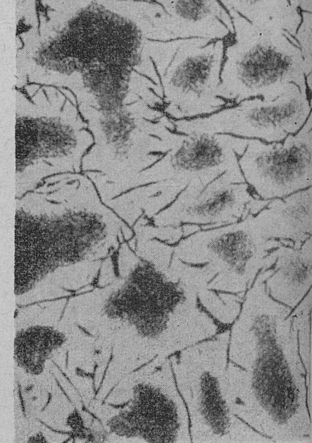
Rys. 10 — Żeliwo stopowe 2,03% C, 5,12% Al (traw. kw. azot.)
