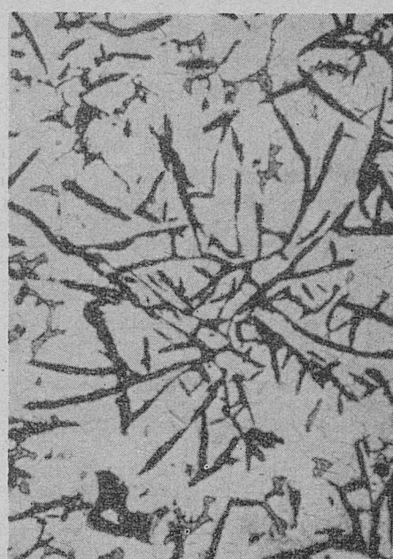
Rys. 13—Żeliwo stopowe 1,46% Al, 0,95% Cu (traw. kw. azot.)
