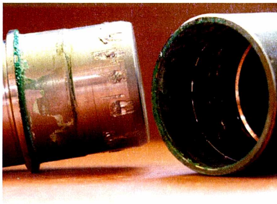
Rys. 6.20. Ślady na współpracujących powierzchniach czopa i rury po rozerwaniu
